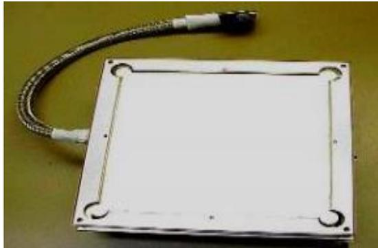
Un analizzatore di particelle di polvere, imbarcato sul cubesat orbitante Phobos, esegue misurazioni della distribuzione delle dimensioni e dell'abbondanza delle particelle di polvere sospese nell'atmosfera (INAF)
